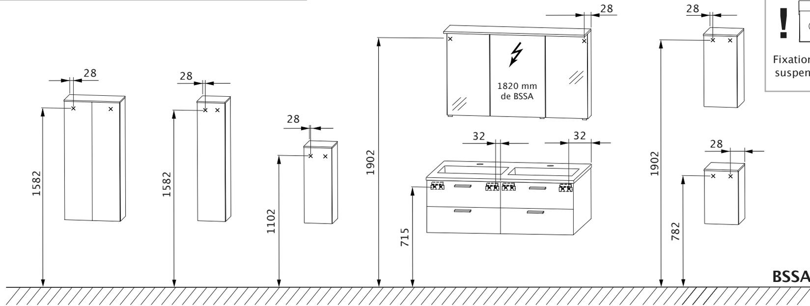
**!** Fixation des barrettes de suspension à l'aide de 2 vis !
